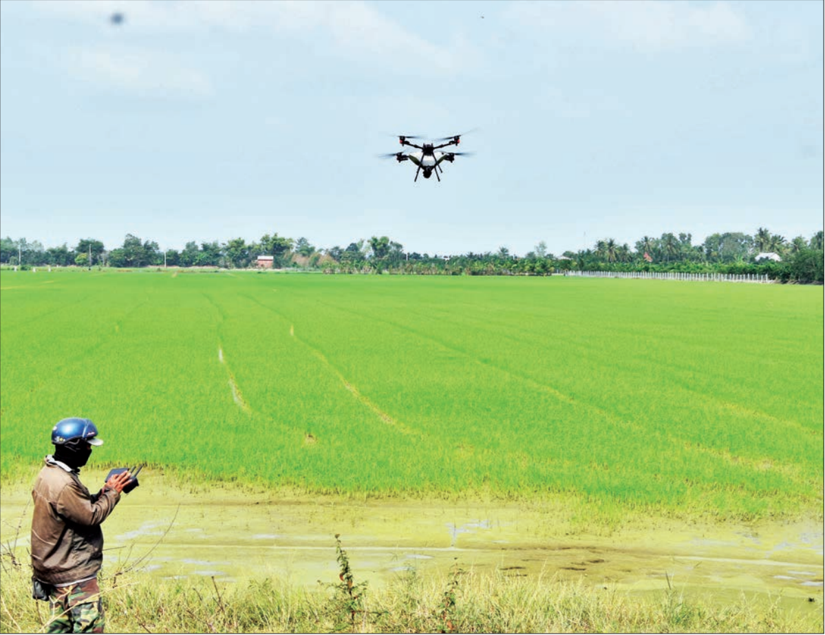
Nông dân xã Mỹ Thành (tỉnh Đồng Tháp) sử dụng thiết bị bay không người lái (drone) phun phân bón trên ruộng lúa.
